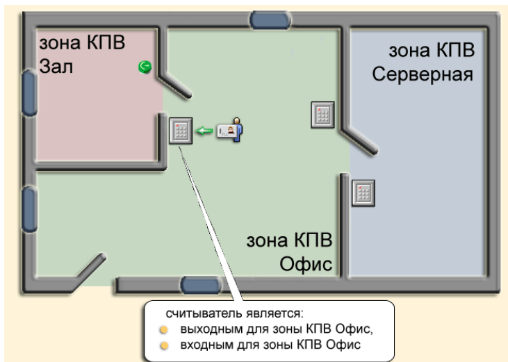
Рисунок Считыватель внутри определенной зоны КПВ
