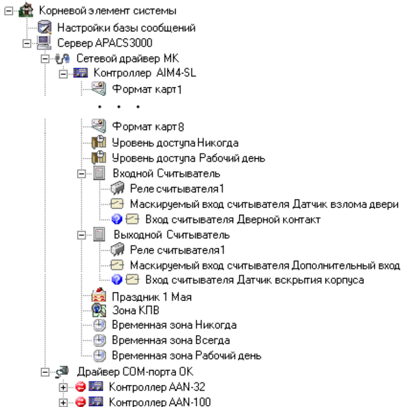
Рисунок Пример дерева системы, отображающегося в окне Проводник при подключении малого контроллера AIM-4SL
