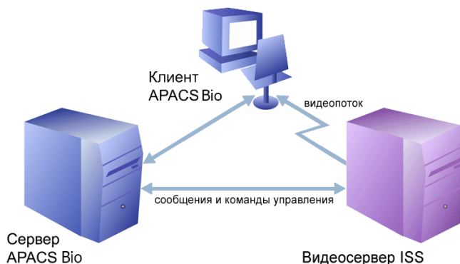
Рисунок Архитектура работы ПК APACS Bio с оборудованием видеонаблюдения ISS
